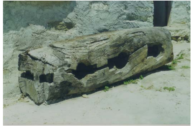
Απανάρι ξύλινης πρέσας, Αποίκια. The upper block of the oil press at Apikia.
