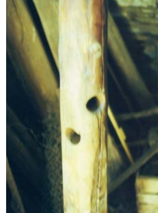
Ο εργάτης με τις τρύπες για τις μανέλες. Man driven crank, the holes are for inserting driving levers.
