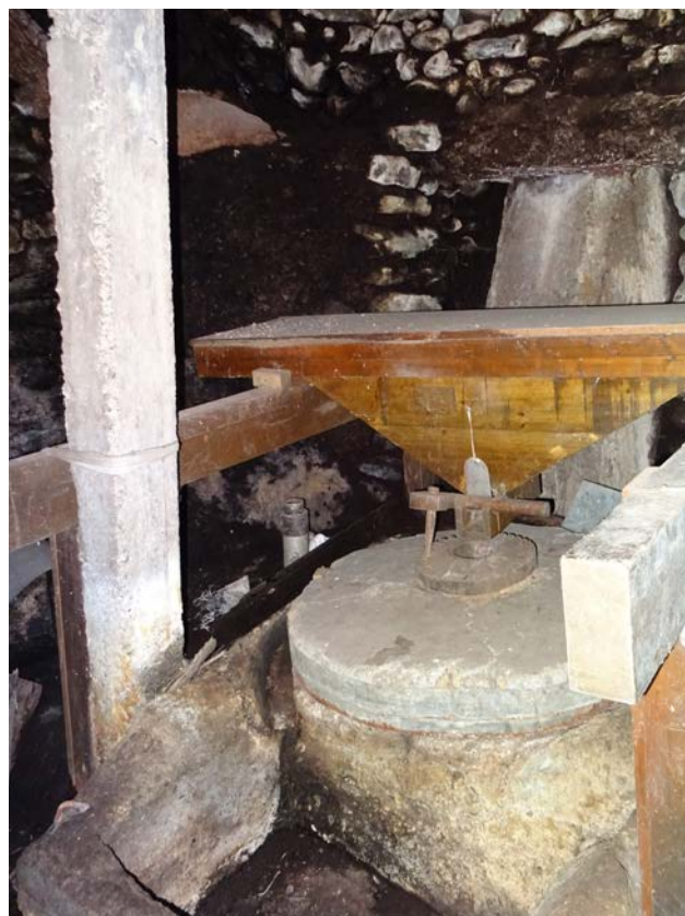
Εικ.3. Ο αλεστικός μηχανισμός όπως διασώζεται στο «Κουτσομυλάκι». Διακρίνονται η ξύλινη κοφινίδα, οι μολόπετρες στη θέση τους και η κτιστή αλευροκασέλα (φωτ. Στέφανου Νομικού).
