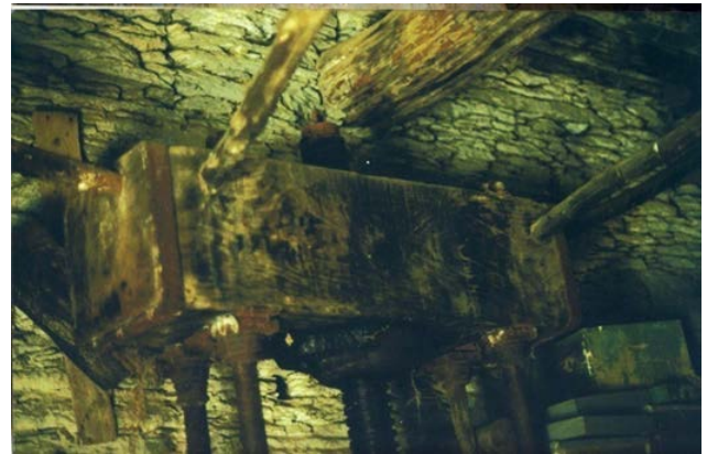
Ξύλινο απανάρι με σιδερένια βίδα και αντηρίδες στήριξης. The wooden upper block of the oil press and its supports.
