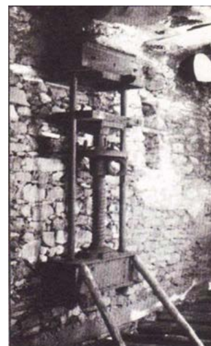
Χυτοσιδηρά πρέσα με αντηρίδες στήριξης, σημειώστε την υποσύλωση. Cast iron oil press and its supports.
