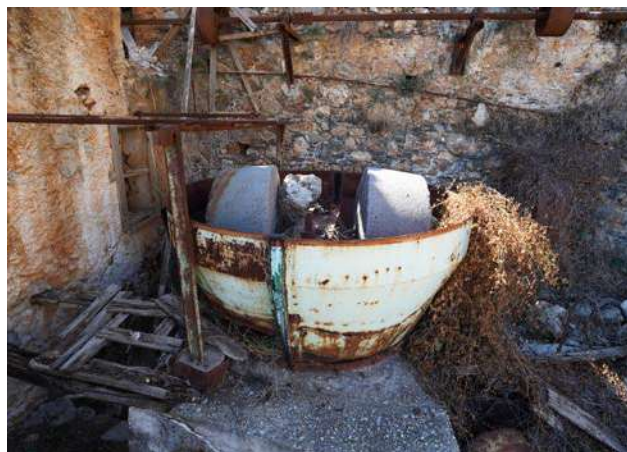
Εικ. 2 Η μεταλλική γούρνα με τις δύο μυλόπετρες του λιοτριβιού μέσα στο χωριό.
