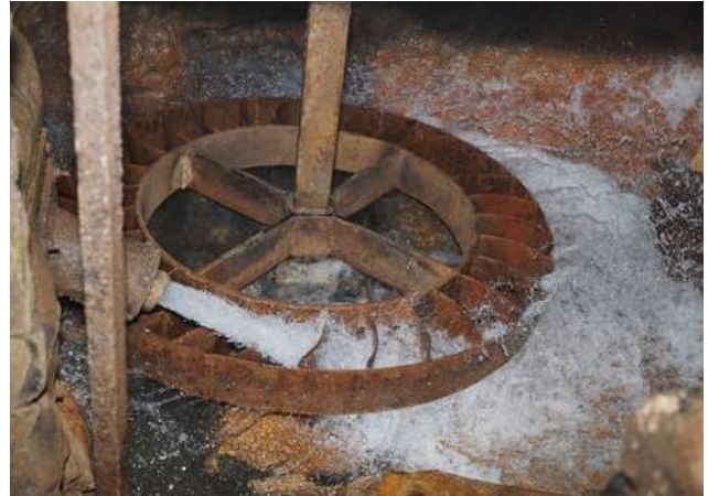
Εικ. 25 Το νερό εκτινάσσεται από το φυσούνι στα πτερύγια της φτερωτής μέσα στο ζωριό την ώρα λειτουργίας του μύλου.
