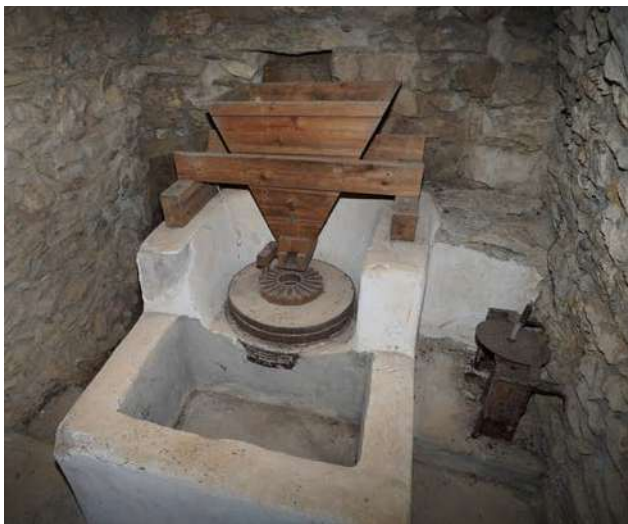
Εικ. 17 Ο αλεστικός μηχανισμός, με πολύ μικρές μυλόπετρες, του αποκατεστημένου νερόμυλου, που είναι ο μοναδικός που αλέθει σήμερα στο Παραδείσι.
