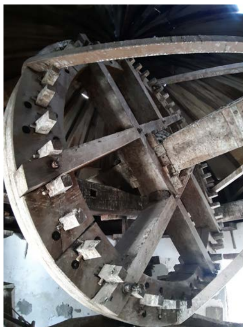
Εικ. 30 Μηχανισμός άλεσης του μεσαιού ανεμόμυλου στο λιμενοβραχίονα του Αγ. Νικολάου.
