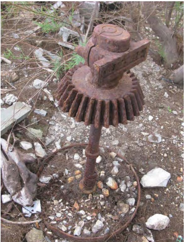
4. Το γωνιακό γρανάζι μετάδοσης κίνησης στο μύλο The angle gear
